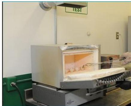
**Figure 1.17-** Four pour la calcination des liants
