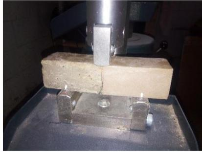
**Figure I.29-** Essai de traction par flexion
