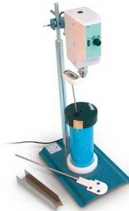
**Figure II.7-** Appareillage utilisé pour la mesure de la réactivité de la chaux
