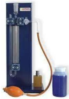
**Figure 1.18-** Perméabilimètre de Blaine
