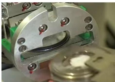
**Figure I.24**-Insertion de la pastille dans le DRX
