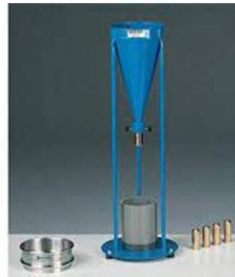
Figure I.7- Cône de Marsh pour ciment
