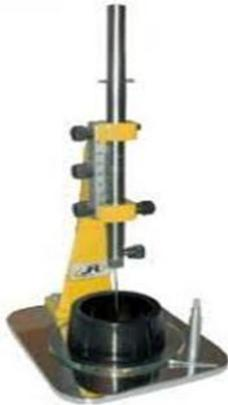
Figure I.6- Appareil de Vicat
