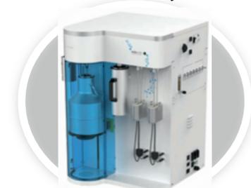
Analyseur pour mesurer la surface spécifique et le volume des solides. Il permet de mesurer la physisorption de surface spécifique de l'azote (0,1 m<sup>2</sup> / g) ou de l'argon (0,0005 m<sup>2</sup> / g) et la taille des pores de 0,35 nm à 400 nm
