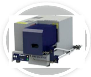
Analyse thermique simultanée (STA) désigne généralement l'application simultanée de la thermogravimétrie (TG) et de l'analyse thermique différentielle (DTA) à un seul et même échantillon dans un seul instrument. Les conditions de mesure sont parfaitement identiques pour les signaux TG et DTA (même atmosphère, même débit de gaz, même pression de vapeur de l'échantillon, même vitesse de chauffage, même contact thermique avec le creuset et le capteur, même effet de rayonnement...
