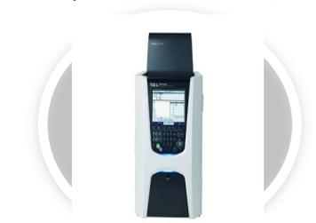
carbone organique adaptés à vos échantillons. Oxydation complète par combustion catalytique à 680 °C sur catalyseur exclusif Platine Sensibilité : détecteur NDIR thermostaté Gamme de mesures étendue : de 4 µg/l à 30 000 mg/l.
